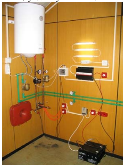
Слика 7. Лабораторијска инсталација енергетских потрошача хибридних соларних пријемника - ЕП-Лаб
